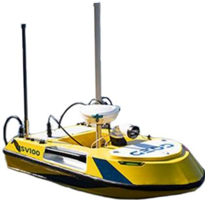
Robuste et léger, le drone marin USV100 est équipé de l'antenne GNSS BALI et de son webserver intégré, simple à utiliser (en mode manuel ou autonome) et ne nécessitant aucun logiciel d'hydrographie. Facile à mettre en œuvre par un seul opérateur, l'USV100 réalise des levés hydrographiques et bathymétriques avec une précision centimétrique.
