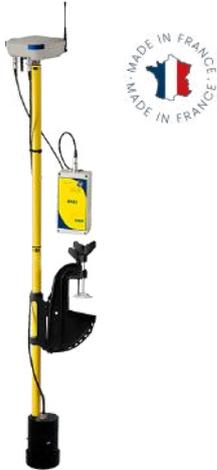
Le système de mesure bathymétrique BALI (« Bathymetry Light ») est un kit compact et autonome simple à opérer et tenant sur une canne unique.
